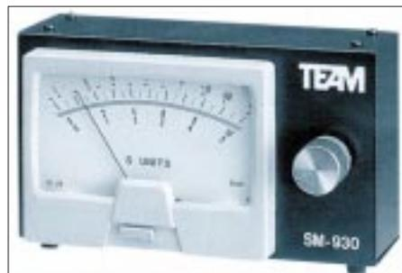
Die Firma TEAM Electronic bietet mit dem SM-930 ein externes Signalstärke-Meßgerät für alle 27-MHz-Funkgeräte. Für die Skalenbeleuchtung ist ein separates Netzteil erforderlich.
