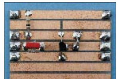
Der NF-Verstärker, aufgebaut auf einer Streifenleiterplatte
