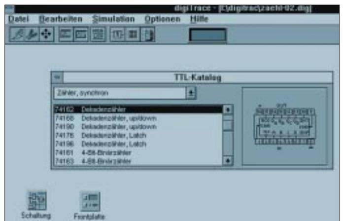
Bild 12: Im Programm digiTrace kann man auf einen TTL-Katalog zugreifen. Er enthält Rubriken für Gatter, Flip-Flops, Zähler, sonstige Bauteile, Bedienelemente, Hardware für an einer Schnittstelle anzuschließende Ein- und Ausgab.
