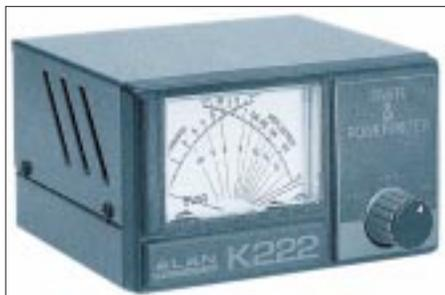
Das K222 von ALAN Electronics ist ein übersichtliches SWR-/Wattmeter mit Kreuzzeigermeßwerk, mit dem die der Antenne zugeführte und die reflektierte HF-Leistung zeitgleich gemessen werden kann.
